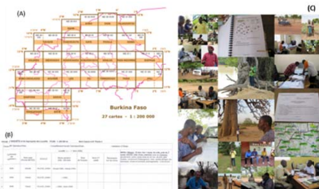
Découpage en feuillets cartographiques (A) Exemple de fiche d'enquête toponymique (B) et Travaux de complètement terrain et d'enquête toponymique en image (C)
